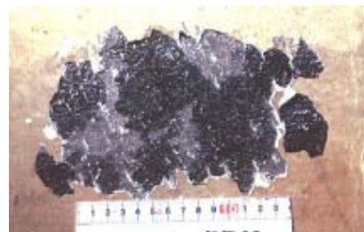
ふくれの下の鋼板には黒さびが発生しているが激しい減肉はない。
